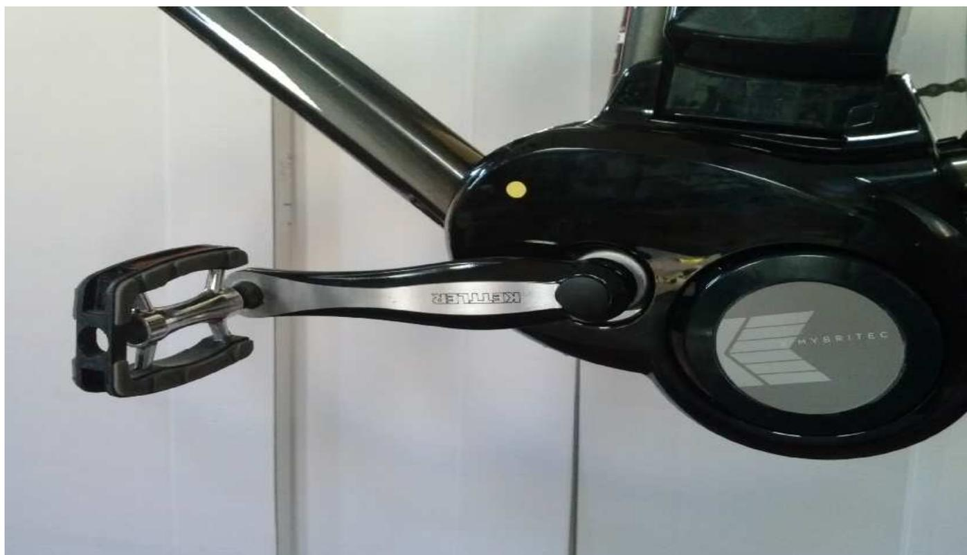
A questo punto se necessario eseguire il settaggio appoggiando un magnete POLARIZZATO SUD al bollino precedentemente incollato sul carter.
