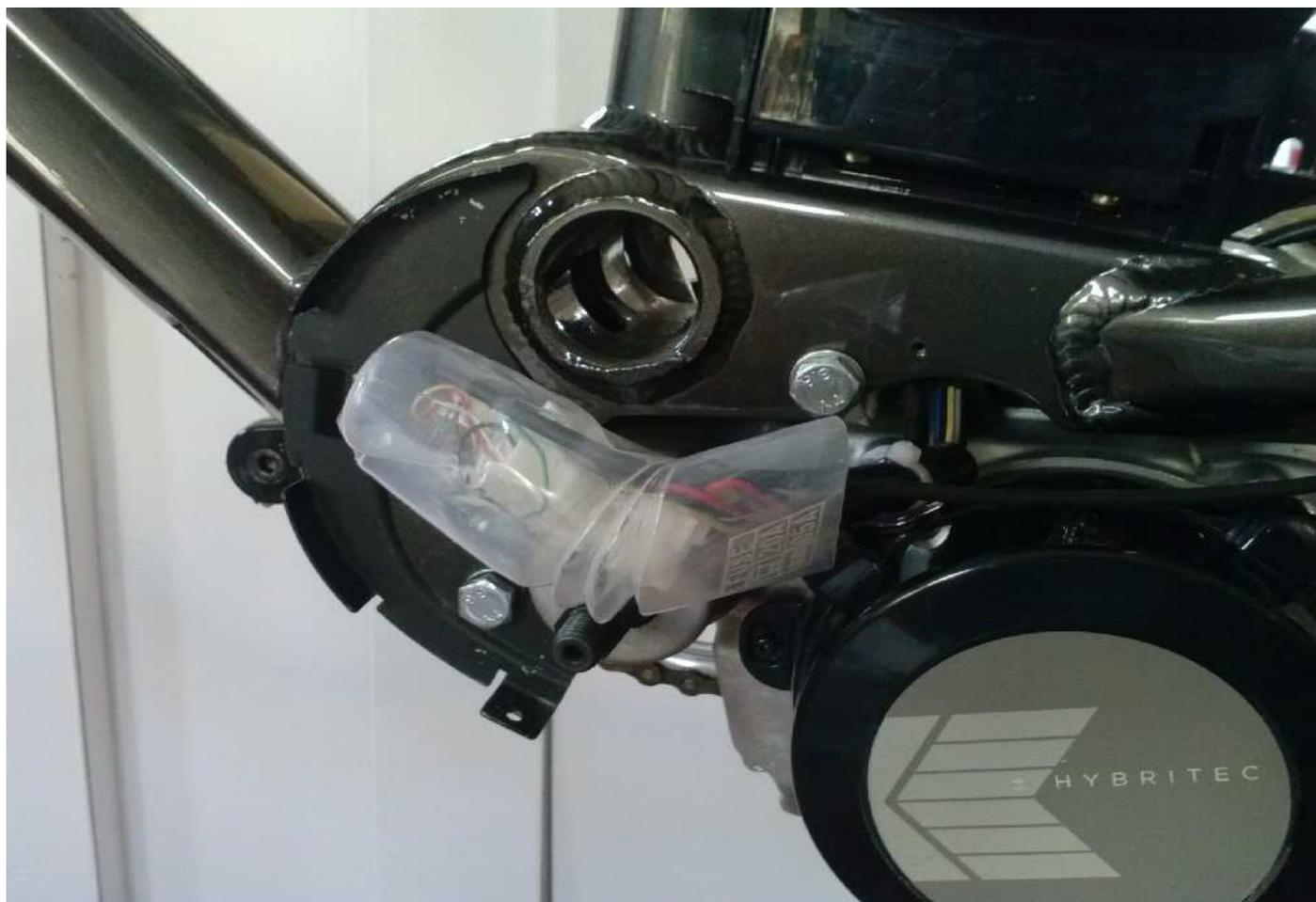
Togliere la capsula trasparente quindi individuare e sconnettere il connettore che proviene dal sensore di velocità della ruota posteriore.
